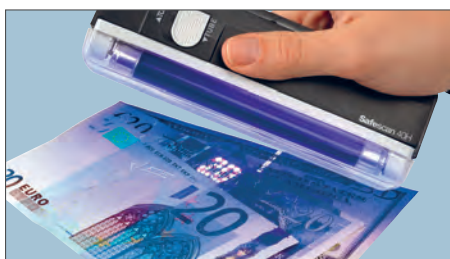
PRÜFUNG DER UV MERKMALE DER BANKNOTE
