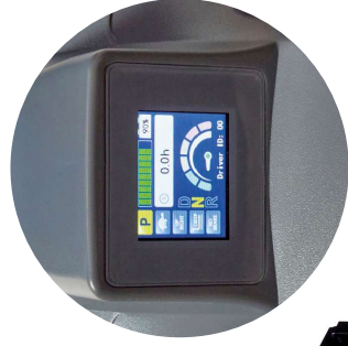
Das digitale Display zeigt übersichtlich Ladestand, Fehlercode, Betriebszeit und Fahrmodus an.
