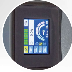
Das digitale Display zeigt übersichtlich Ladezustand, Fehlercode, Betriebszeit und Fahrmodus an.
