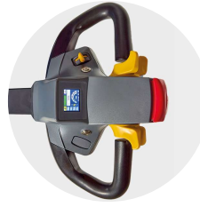
Multifunktionale Deichsel mit einem digitalen Display
