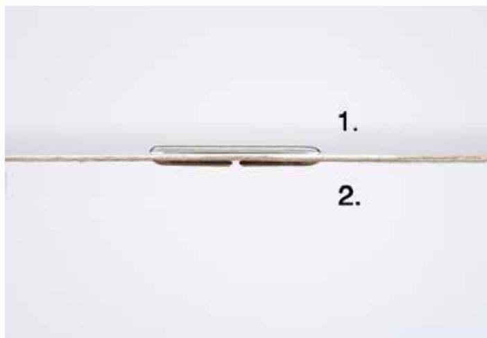
Durch den neuartigen Heftvorgang in zwei Schritten durchstoßen zunächst die Klammerschenkel das Papier, dann werden die Klammerenden absolut flach umgelegt und an das Papier gedrückt.
