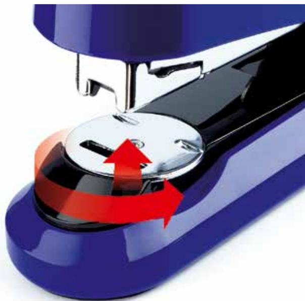
Die Wendematrix ermöglicht die feste und offene Heftung. Die offene Heftung ist optimal für kurzzeitiges Zusammenheften. Vorteil: einfaches und schnelles Entfernen der Heftklammern möglich.
