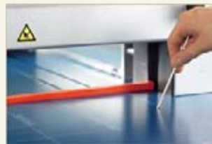
8fach verwendbare, leicht zu wechselnde Schneidleiste.
