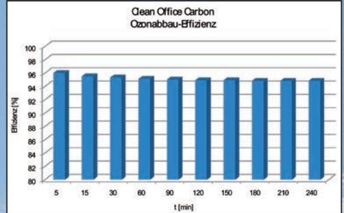
Der Clean Office CARBON besteht aus elektrostatisch geladenem Filtermaterial gegen Feinstäube sowie einer zusätzlichen Schicht **Aktivkohle** gegen Ozon Benzol, Toluol und unangenehme Gerüche.
