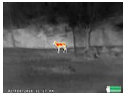
InstAlert: Das wärmste Objekt im Bild wird farbig dargestellt, alle anderen in Graustufen.
