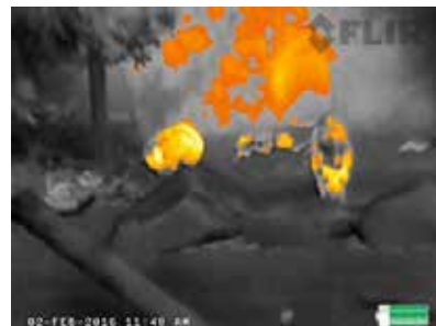
Graded Fire 1&2: Die wärmsten Objekte im Bild werden in einem Farbverlauf dargestellt, alles andere in Graustufen.
