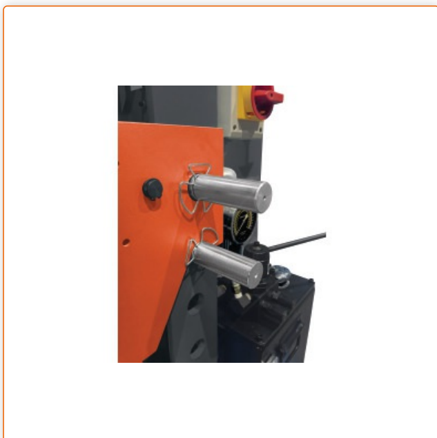
Massive Arretierungsbolzen mit Sicherungsring für die Höheneinstellung des Pressentisches
