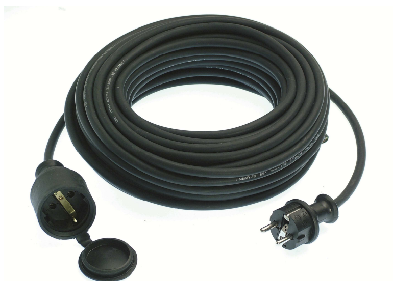
15m leichte Gummischlauchleitung H05RR-F 3G1,5 schwarz.
