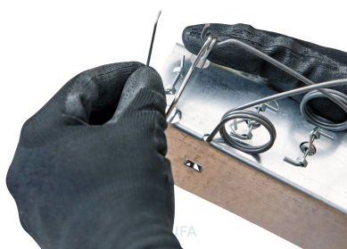
4 – Überbügel über den Schlagbügel legen.
