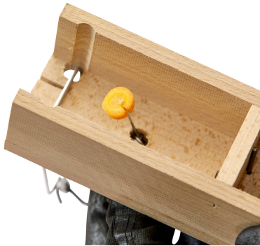
1 – Köder auf Köderhaken stecken (Möhren, Löwenzahnwurzeln, Sellerie etc.).
