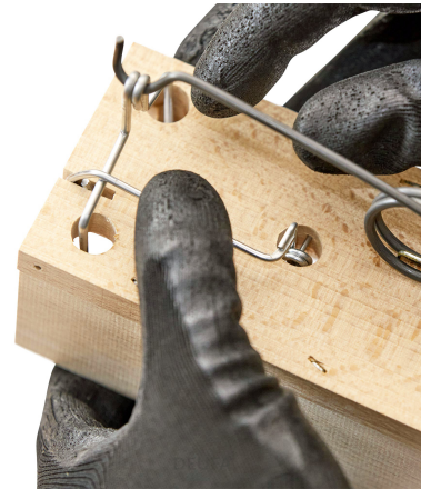
4 – Überbügel im abgeflachten Bereich unter Köderhaken einhängen. Schritte 1-4 für die zweiseitige Kastenfalle wiederholen.
