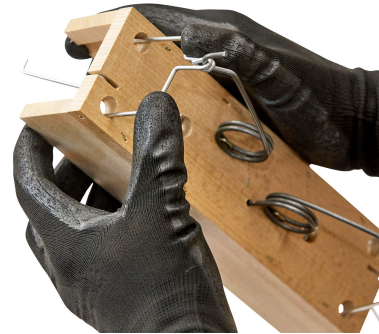
2 – Schlagbügel nach unten drücken, bis die Feder den Fallendeckel berührt. Achtung – beim Drücken des Schlagbügels auf keinen Fall vom Eingang her in den Schlagbügel greifen! Hier herrscht Quetschgefahr!
