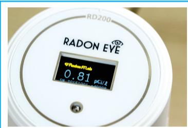
4. Falls bei der Messung mit dem Radon Eye eine Konzentration von 148 Bq/m<sup>3</sup> überschritten wird, ertönt automatisch ein Alarmsignal. Diesen Alarmwert können Sie individuell in der App festlegen.
