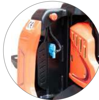
Akkuanschluss mit Not-Aus-Knopf
