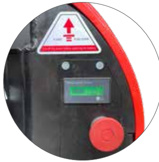
Batterieladestand- und Betriebsstundenanzeige mit Not-Aus-Knopf
