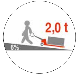
6 % Steigfähigkeit bei Vollast
