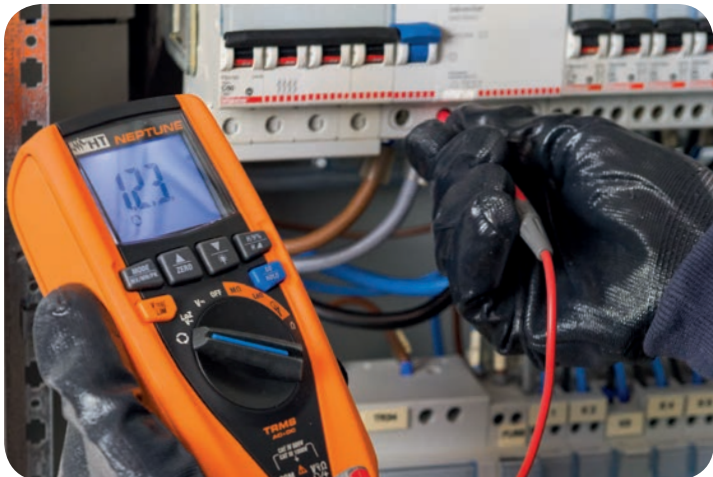
Drehfeldrichtung mit 1-phasiger Methode.
