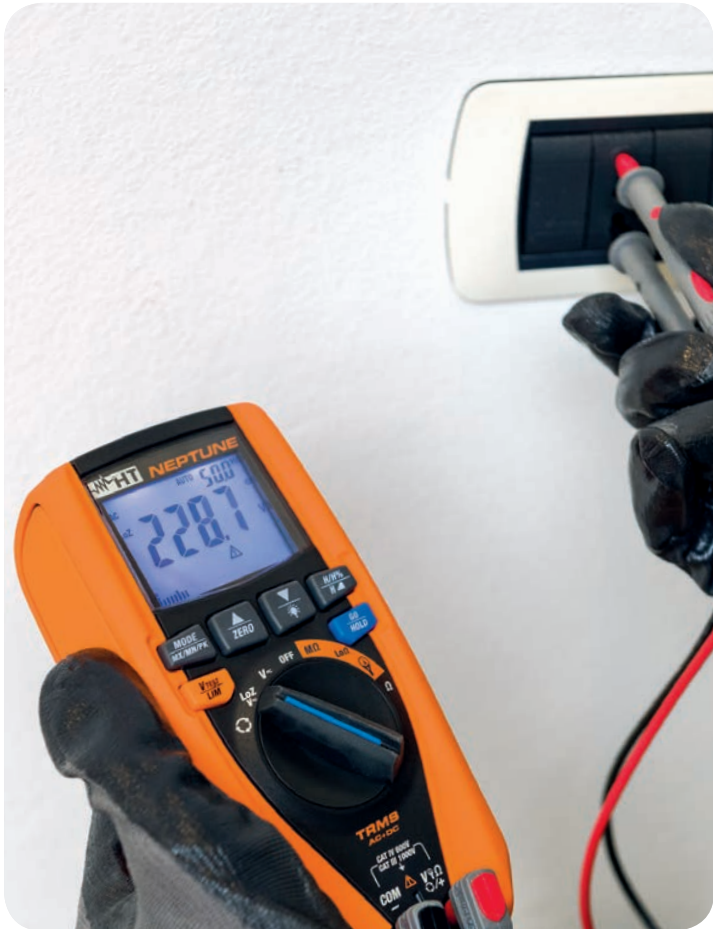
LoZ Funktion eliminiert Streuspannungen.
