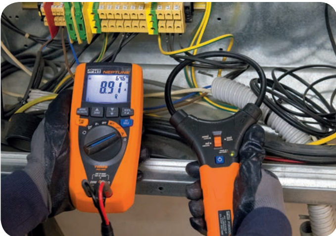
Messung des Stroms mit flexiblem Wandler F3000U.
