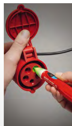
Drehfeldprüfung Grün = Rechtsdrehfeld
