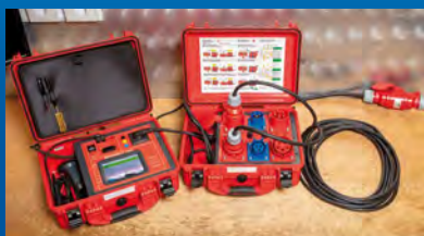
Prüfung einer 5-poligen CEE-Verlängerung
