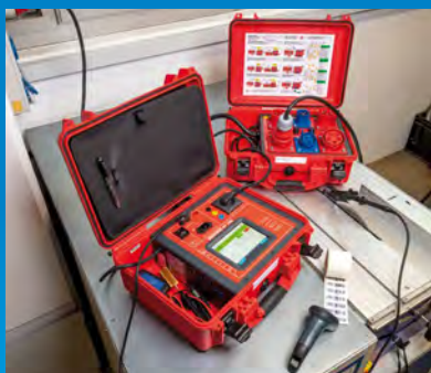
Aktive Prüfung einer 3-phasigen Tischkreissäge
