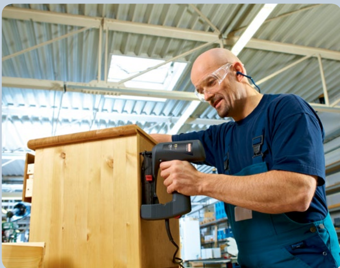
Schnelles Nageln von z.B. Möbelrückwänden mit dem Tacker.
