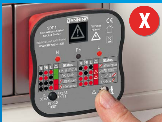
Steckdose mit Verdrahtungsfehler, Lebensgefahr! Außenleiter (L) und Schutzleiter (PE) wurden vertauscht!
