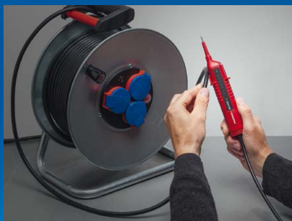
Lokalisierung von Kabelbrüchen
