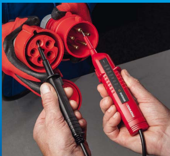
Durchgangsprüfung an Leitungen
