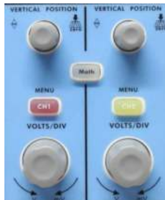
Abb. 11 Bedienelemente für Vertikalsteuerung
