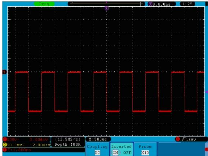
Abb. 17 Wellenform nicht invertiert
