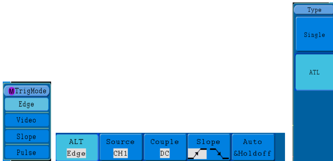
Abb.34 Menü für alternierenden Trigger (ALT) (Triggertyp: Edge)
