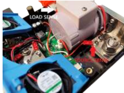
Getauschte Drähte für umgekehrte Stromverteilung
