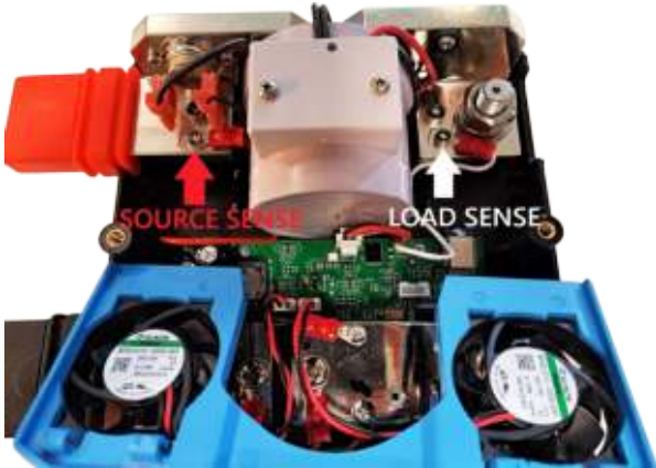
Spannungsmessung von Quelle und Last
