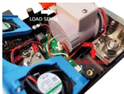
Getauschte Drähte für umgekehrte Stromverteilung
