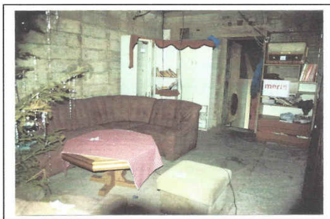
Abbildungen 12 und 13: Brandlastverteilung im Versuchsraum
