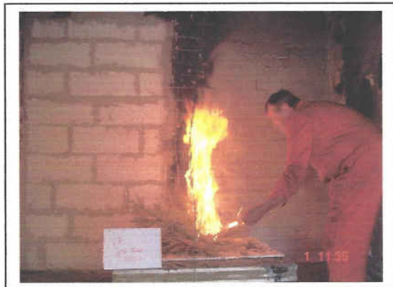
Abbildung 27: unbehandelte Fichte (10 s)
