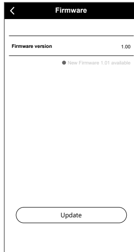
(b) Ihre aktuelle Firmware-Version wird angezeigt. Tippen Sie auf "Aktualisieren", wenn eine neue Firmware verfügbar ist (angezeigt durch einen roten Punkt).
