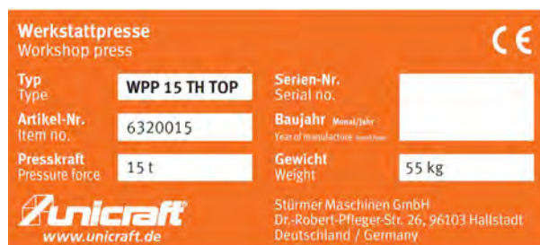
Abb. 5: Typenschild der hydraulischen Werkstattpresse WPP 15 TH TOP
