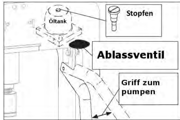
Abb. 29: Entlüften des Hydrauliksystems bei der WPP 15 TH TOP
