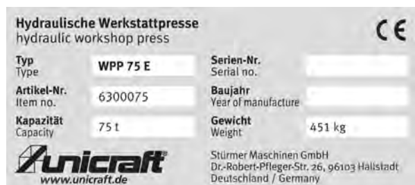
Abb. 3: Typenschild der hydraulischen Werkstattpresse WPP 75 E
