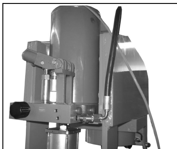
Abb. 15: Der kurze Schlauch montieren
