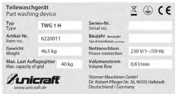
Abb. 2: Typenschild Teilewaschgerät TWG 1 H
