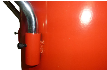
Abb. 6: Griff am Behälter anschrauben
