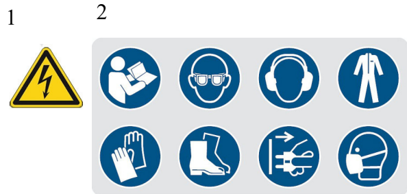
Abb. 1: Sicherheitskennzeichnungen: 1 - Warnzeichen: Warnung vor elektrischer Spannung | 2 - Gebotszeichen: Anleitung beachten, Augenschutz benutzen, Gehörschutz benutzen, Schutzkleidung benutzen, Handschutz benutzen, Fußschutz benutzen, Netzstecker ziehen, Maske benutzen
