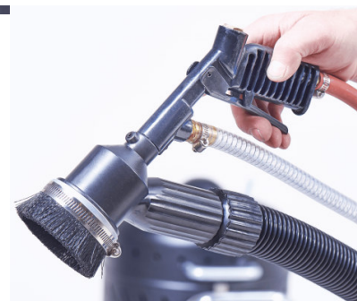
Abb. 7: Schläuche an Behälter und Strahlpistole anschließen
