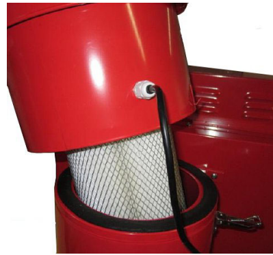
Abb. 15: Filter der Sandstrahlkabine SSK 5
