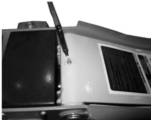
Abb. 8: Schmierstellen am Wagenheber
