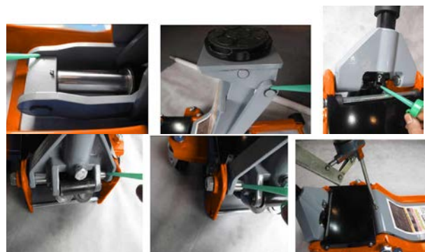
Abb. 8: Schmierstellen am Wagenheber
