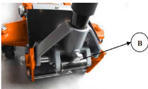
Abb. 6: Montage des Pumphebels am Wagenheber-Körper
