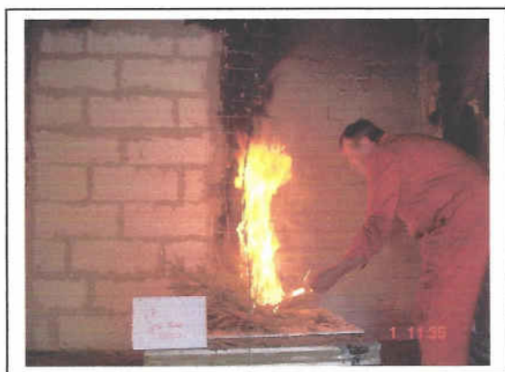
Abbildung 27: unbehandelte Fichte (10 s)
