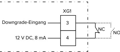
Abb. 15: Prinzipschaltbild: Anschluss eines externen Schaltkontakts (Standard-Einstellung: NO)
