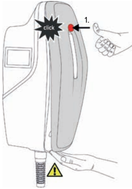
Fig. 18: Colocar la cubierta frontal (ejemplo) - 1
