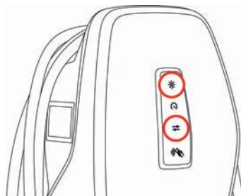
Fig. 11: Attivazione Access Point (esempio)
