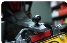
Einbauposition des Motorrads hinten
