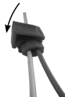
Figure 6 : Fermer le crochet de sécurité
