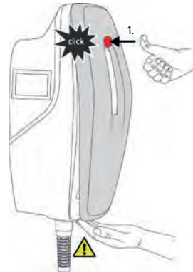
Fig. 20 : Monter le cache frontal - 1
