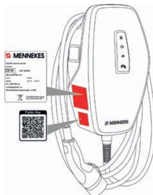
Abb. 5: Platzierung Eichrecht-Typenschild und QR-Code-Aufkleber
