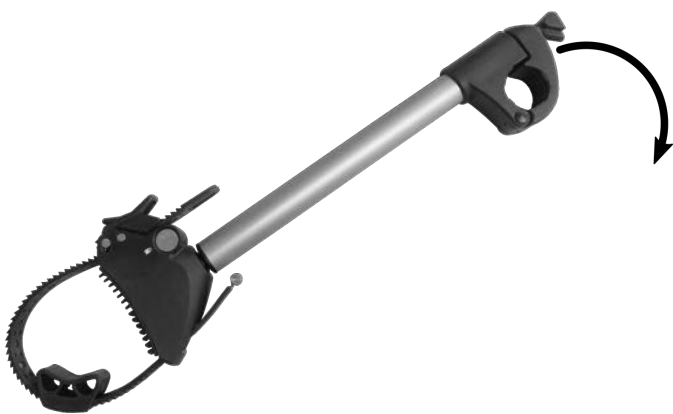
Figura 4: Apertura della pinza
