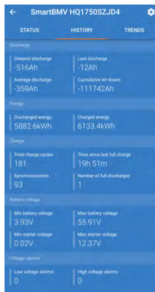
VictronConnect App zeigt die Historie des BMV-Batteriemonitors an
