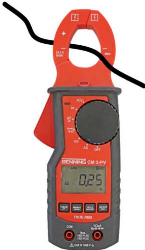
Abb. 10: Strommessung über Messzange (A)
