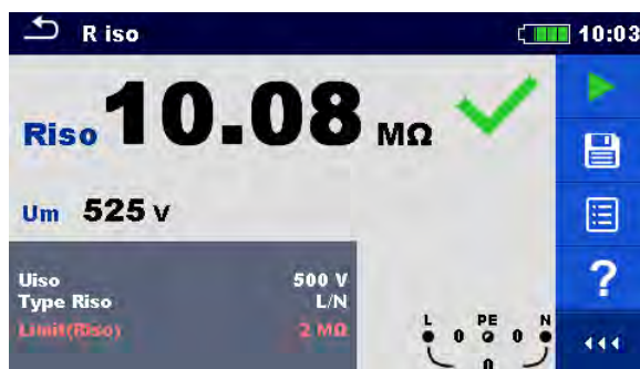
Abbildung 6.1: Bildschirmanzeige einer Einzelprüfung, Beispiel für Isolationswiderstandsmessung
