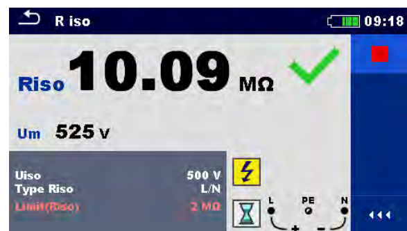
Abbildung 6.1: Bildschirmanzeige einer Einzelprüfung, Beispiel für Isolationswiderstandsmessung
