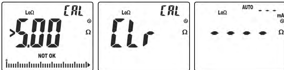
Abb. 34: Ergebnisse einer nicht korrekt durchgeführten Kalibration
