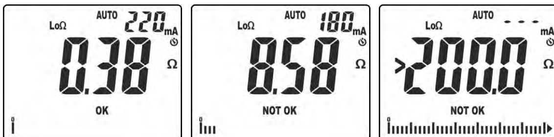
Abb. 28: Ergebnisse der Durchgangsprüfung im Betriebsmodus AUTO
