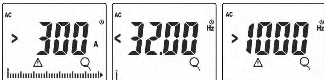
Abb. 39: Anormale Situationen bei der Strommessung mit Strommesszangen
