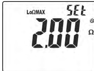
Abb. 26: Einstellung des Grenzwerts bei der Durchgangsprüfung
