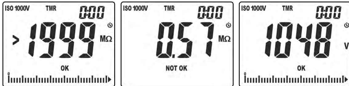
Abb. 21: Ergebnisse der Isolationsmessung in Betriebsmodus TMR
