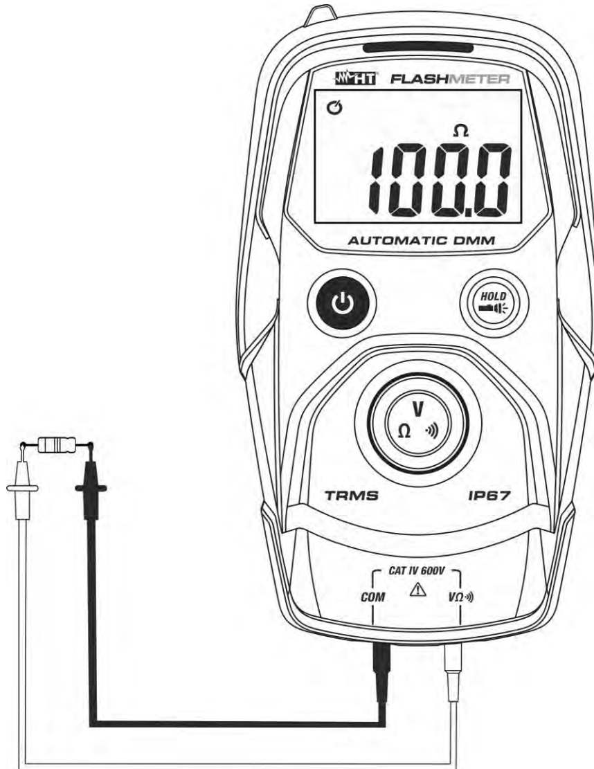
Fig. 5: Mesure de Résistance
