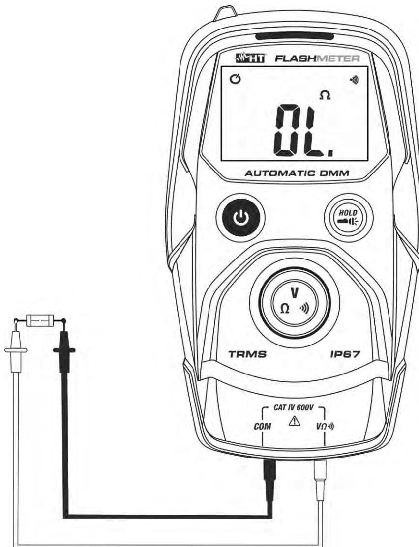
Fig. 6: Uso del instrumento para la prueba de continuidad
