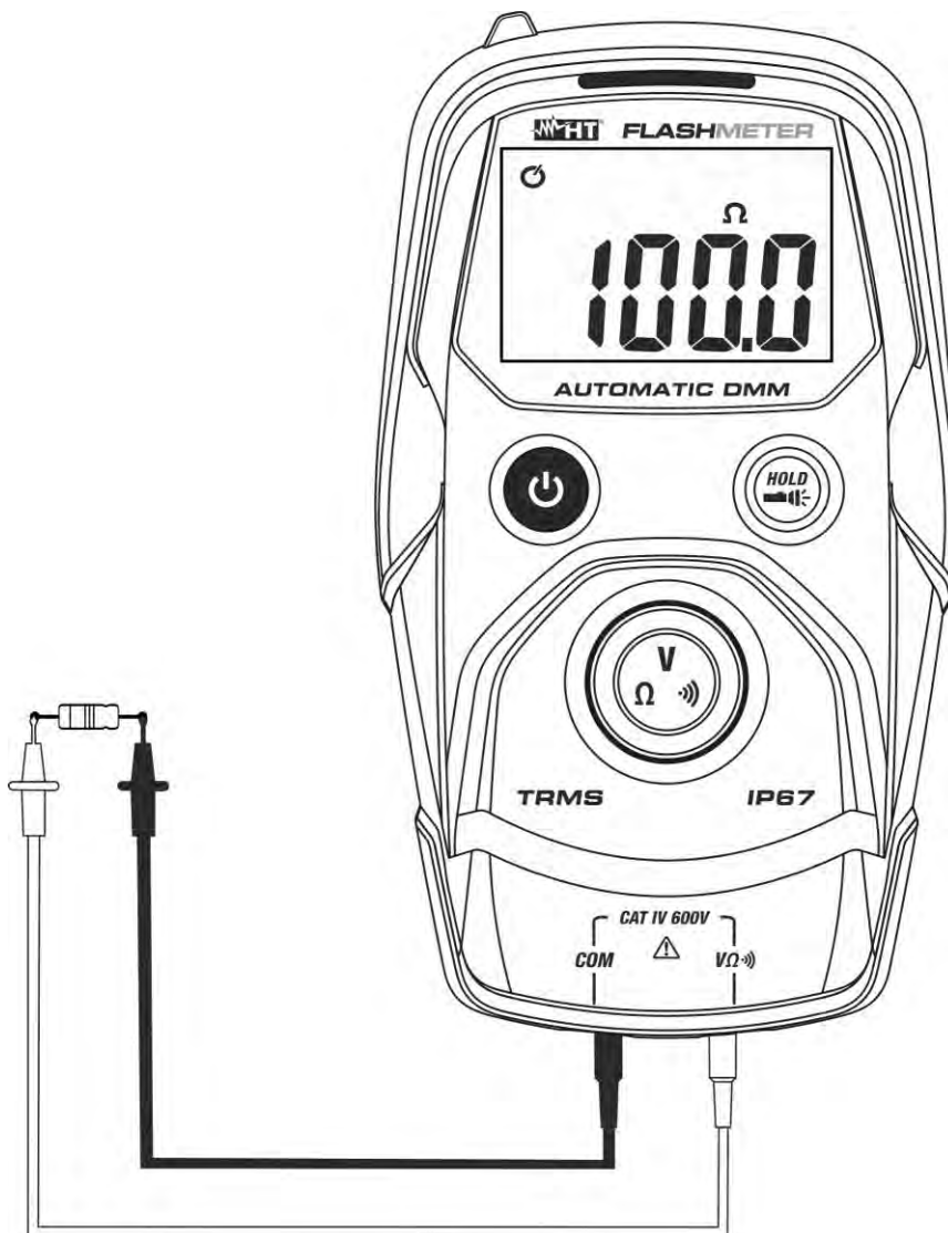
Fig. 5: Uso del instrumento para medida de Resistencia
