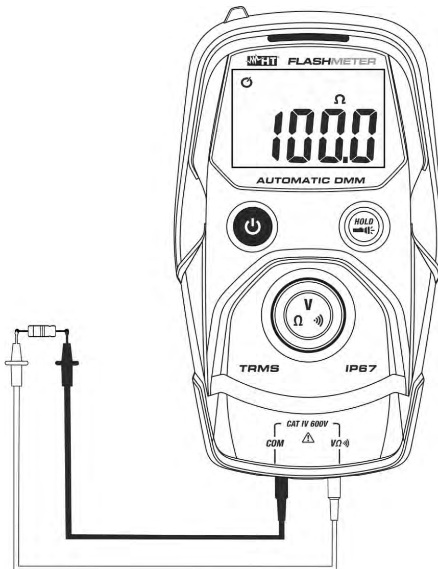
Fig. 5: Uso do instrumento para a medição de Resistências
