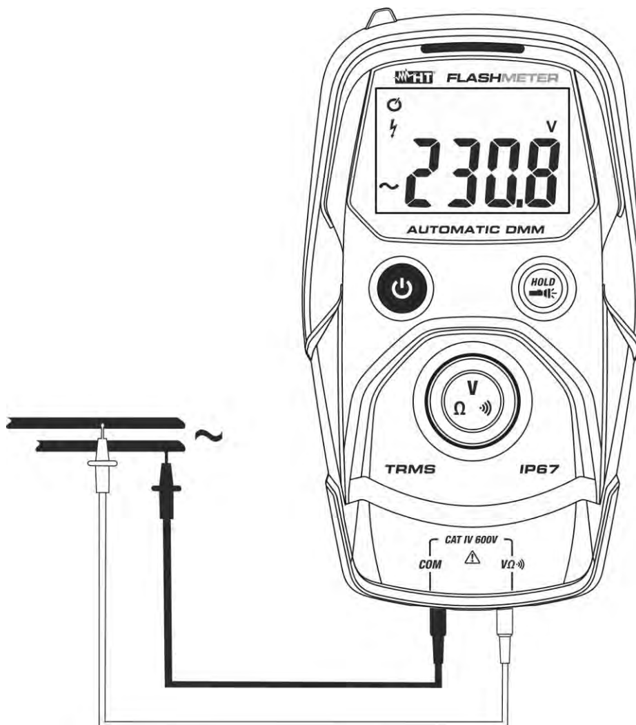
Fig. 4: Uso do instrumento para a medição de Tensões CA
