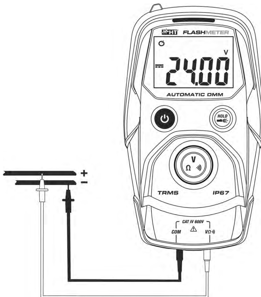
Fig. 3: Uso do instrumento para a medição de Tensões CC
