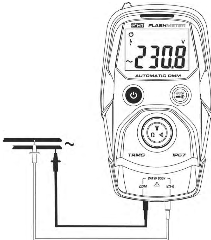
Abb. 4: Verwendung des Gerätes für Wechselspannungsmessung
