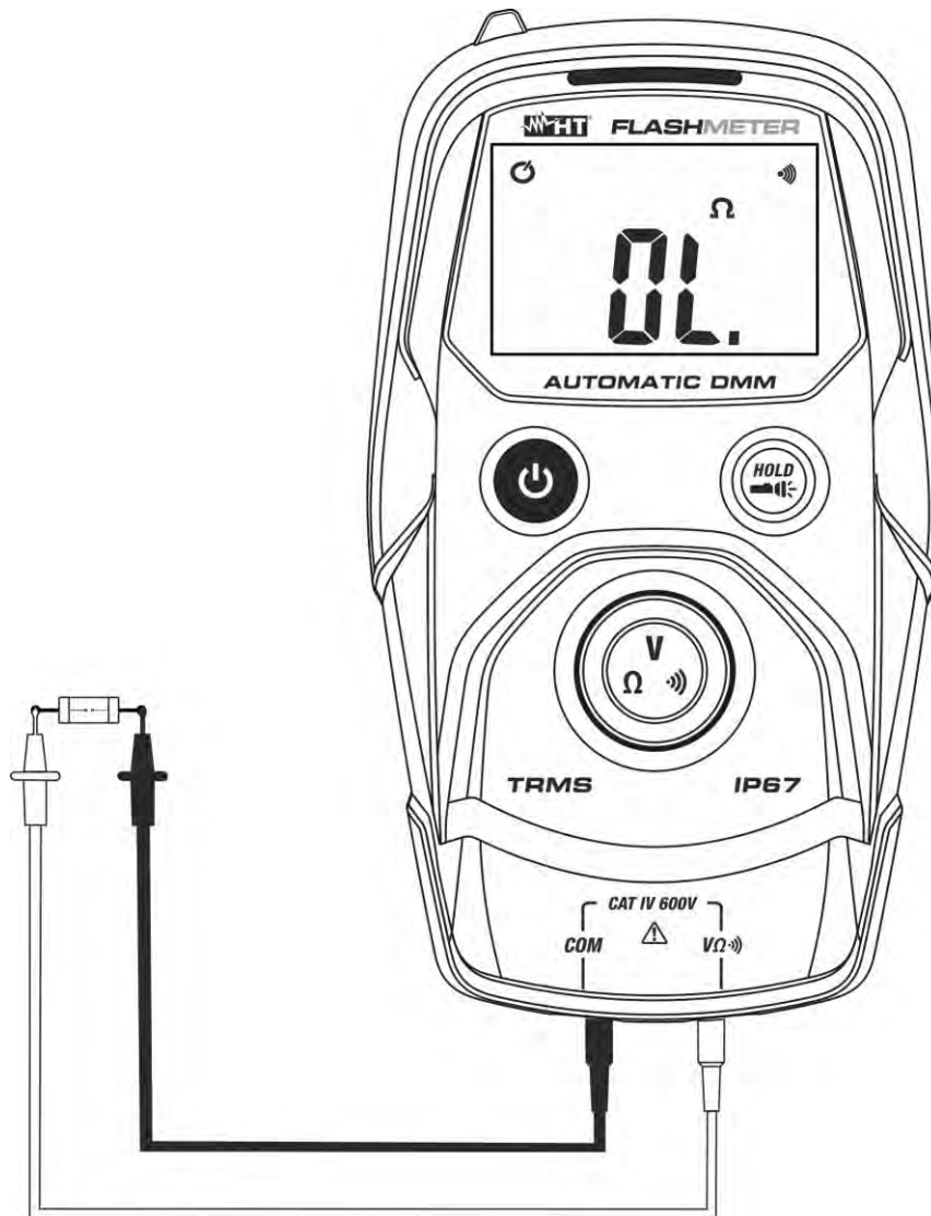
Abb. 6: Verwendung des Gerätes für Durchgangstest
