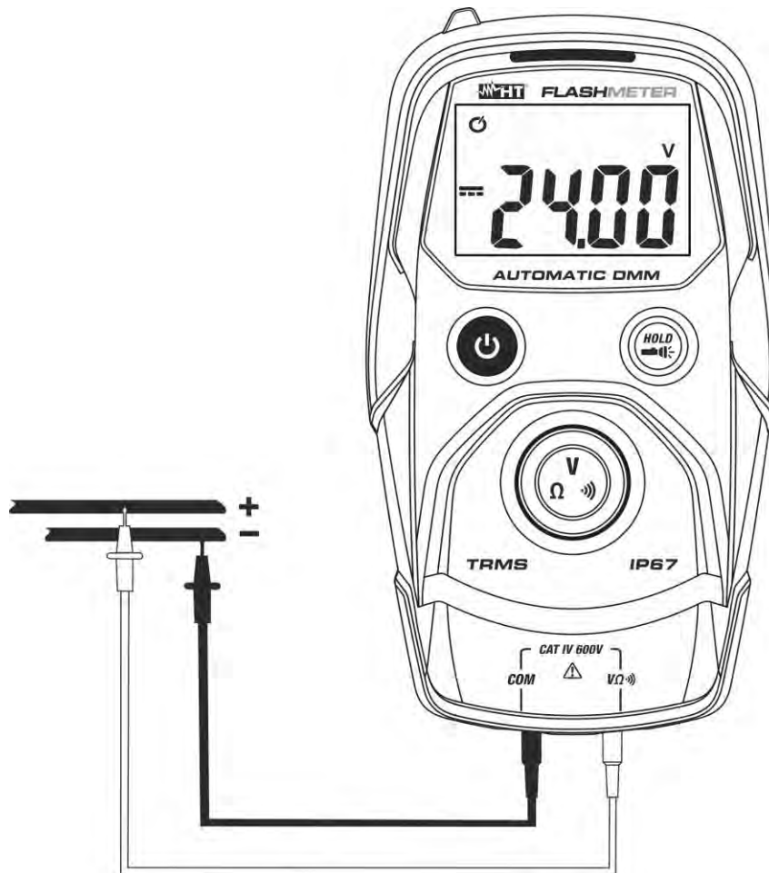
Abb. 3: Verwendung des Gerätes für Gleichspannungsmessung
