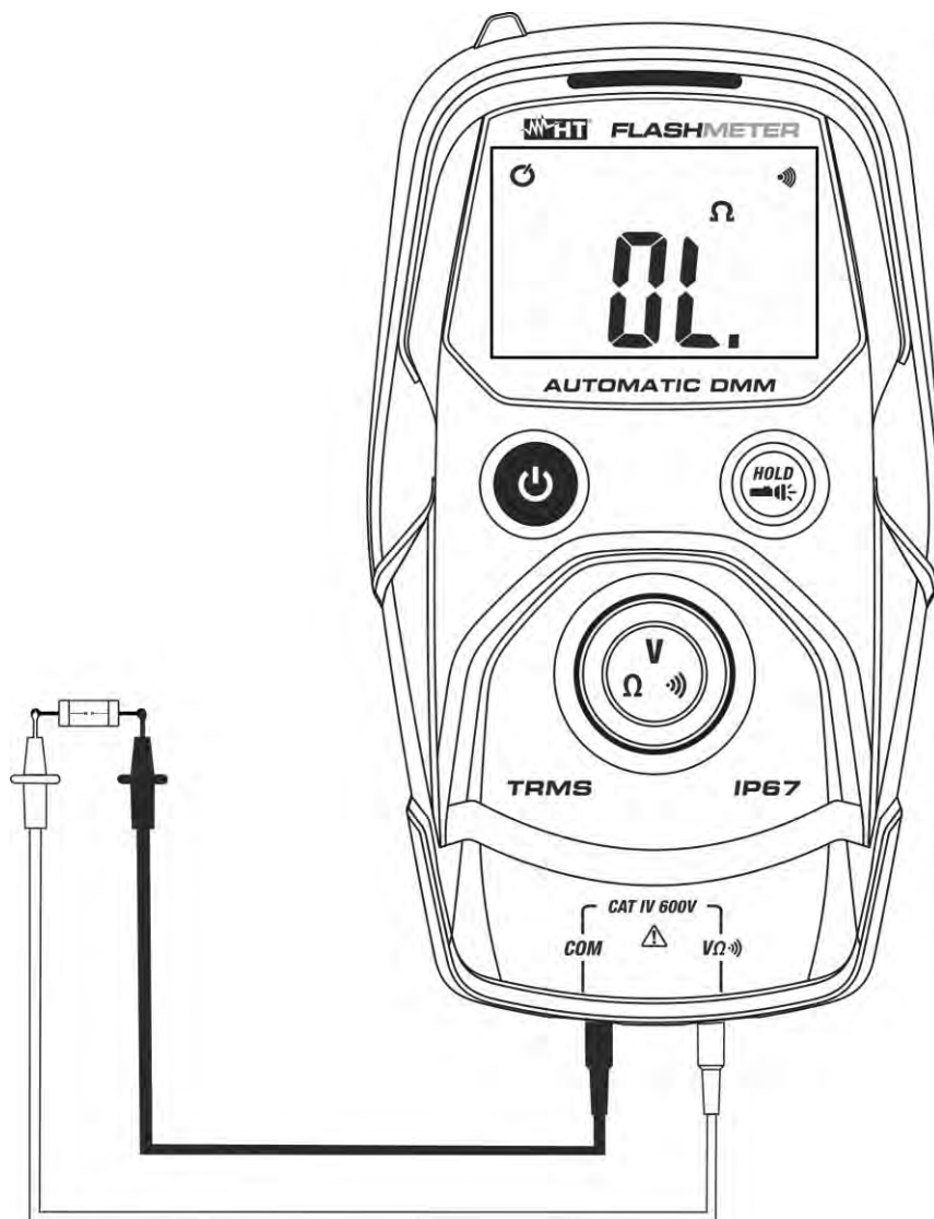
Fig. 6: Uso dello strumento per il Test Continuità
