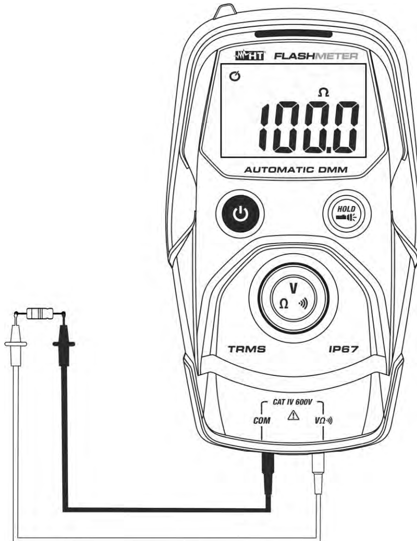
Abb. 5: Verwendung des Gerätes für Widerstandsmessung
