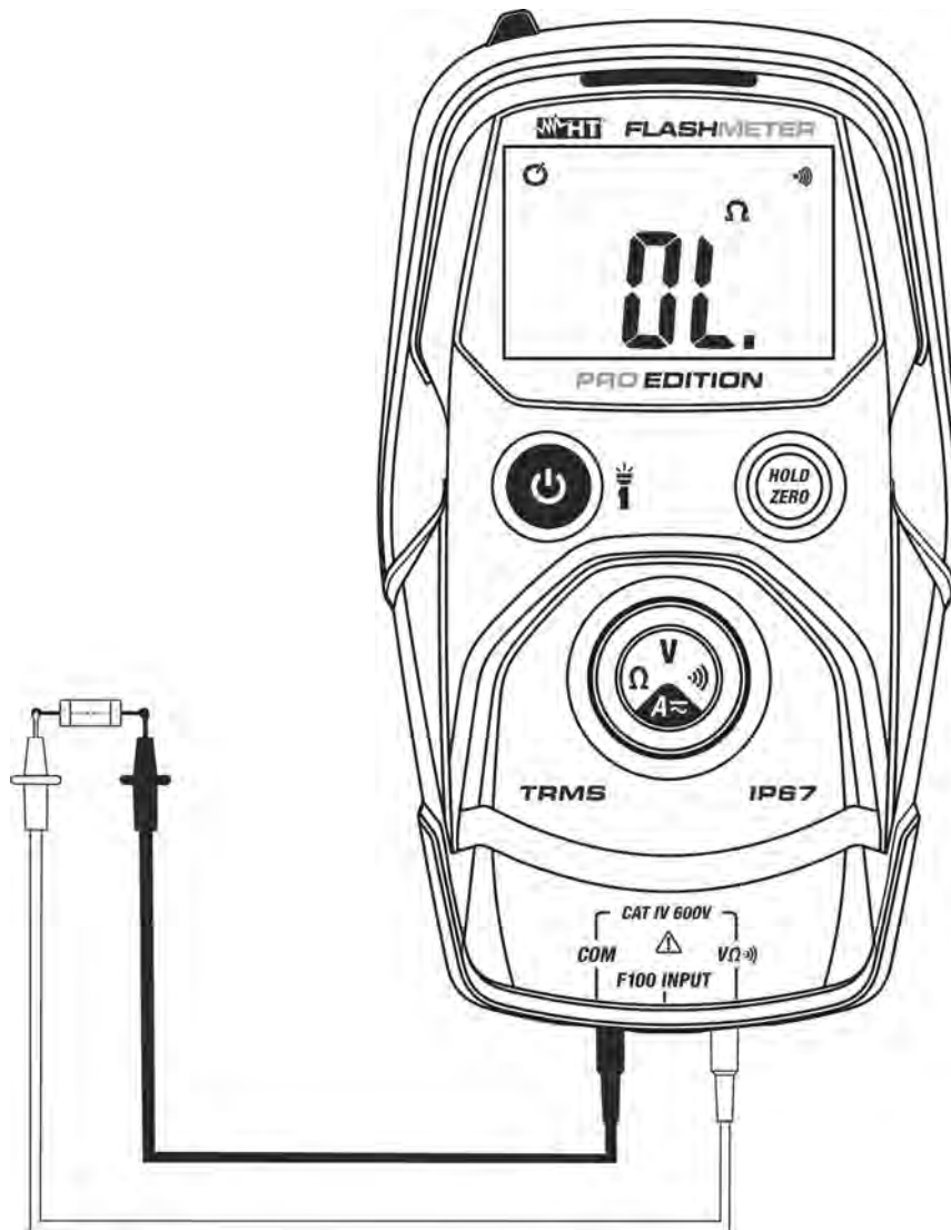
Abb. 6: Verwendung des Gerätes für Durchgangstest
