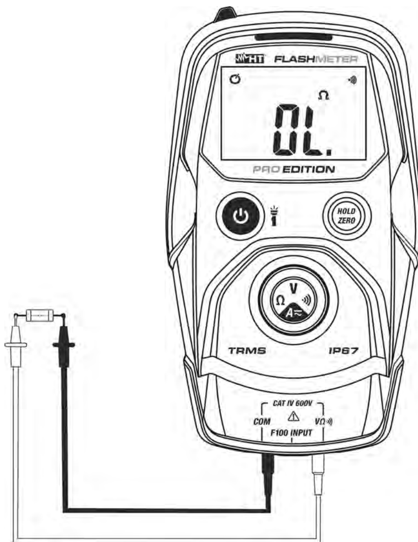
Fig. 6: Uso do instrumento para o Teste de Continuidade
