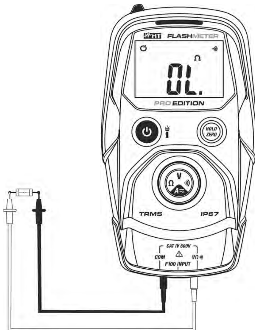
Fig. 6: Uso dello strumento per il Test Continuità
