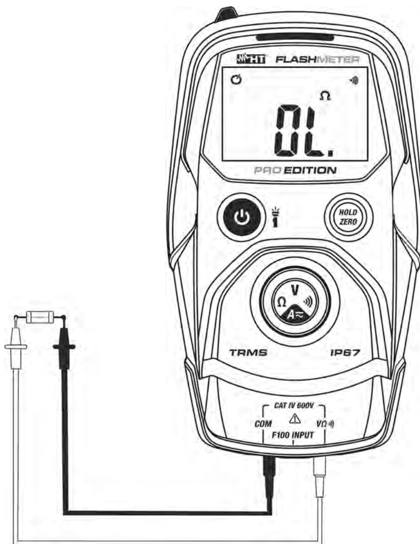
Fig. 6: Utilisation de l'instrument pour le test de continuité
