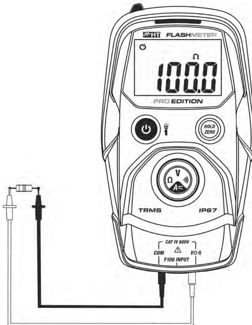
Fig. 5: Uso dello strumento per misura di Resistenza
