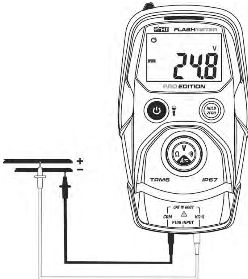
Abb. 3: Verwendung des Gerätes für Gleichspannungsmessung
