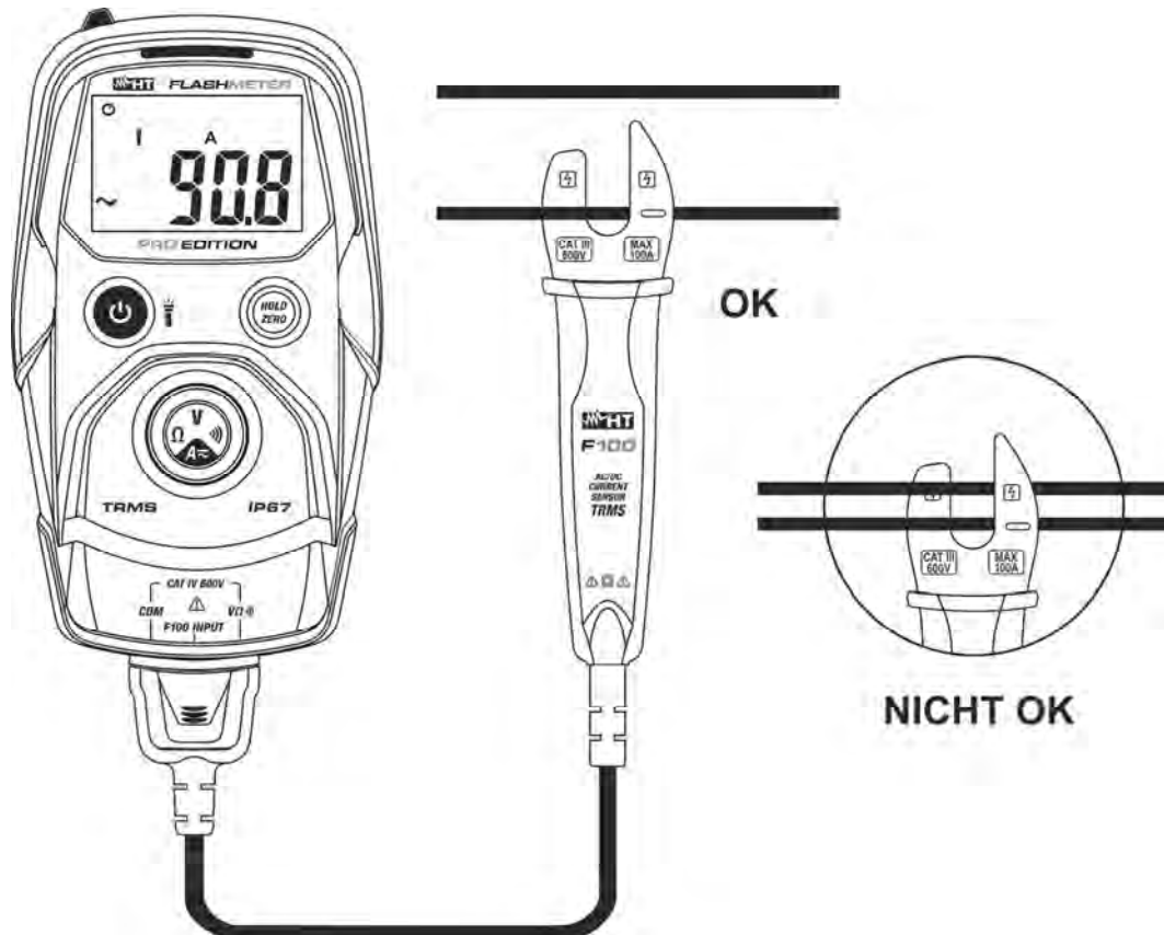
Abb. 7: Verwendung des Gerätes für AC/DC Strommessung
