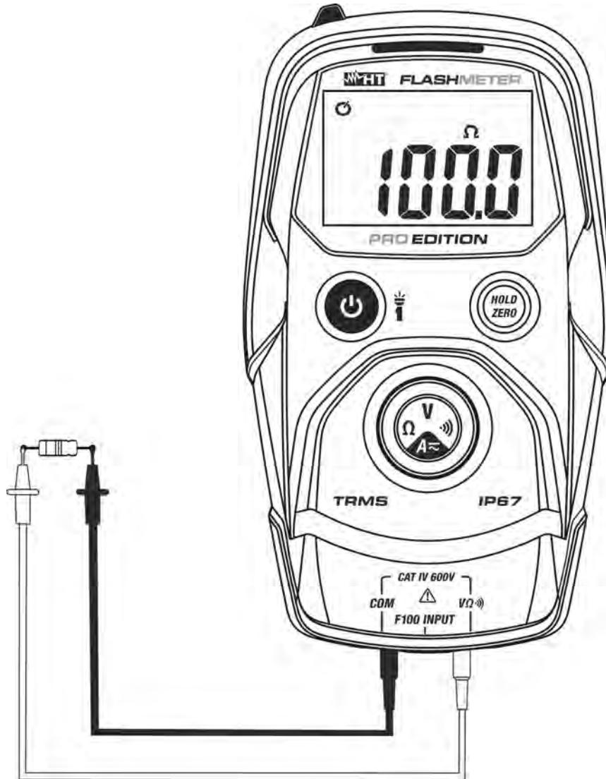
Abb. 5: Verwendung des Gerätes für Widerstandsmessung
