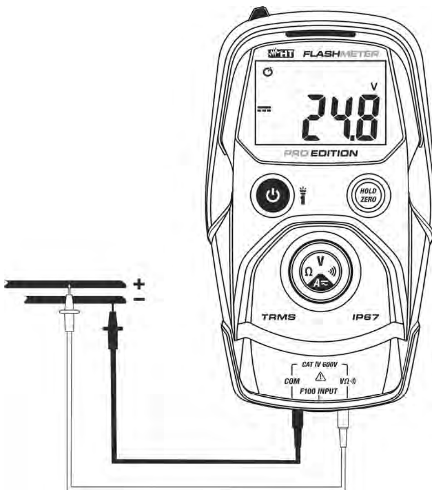
Fig. 3: Uso del instrumento para medida de Tensión CC
