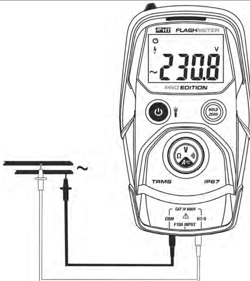
Abb. 4: Verwendung des Gerätes für Wechselspannungsmessung
