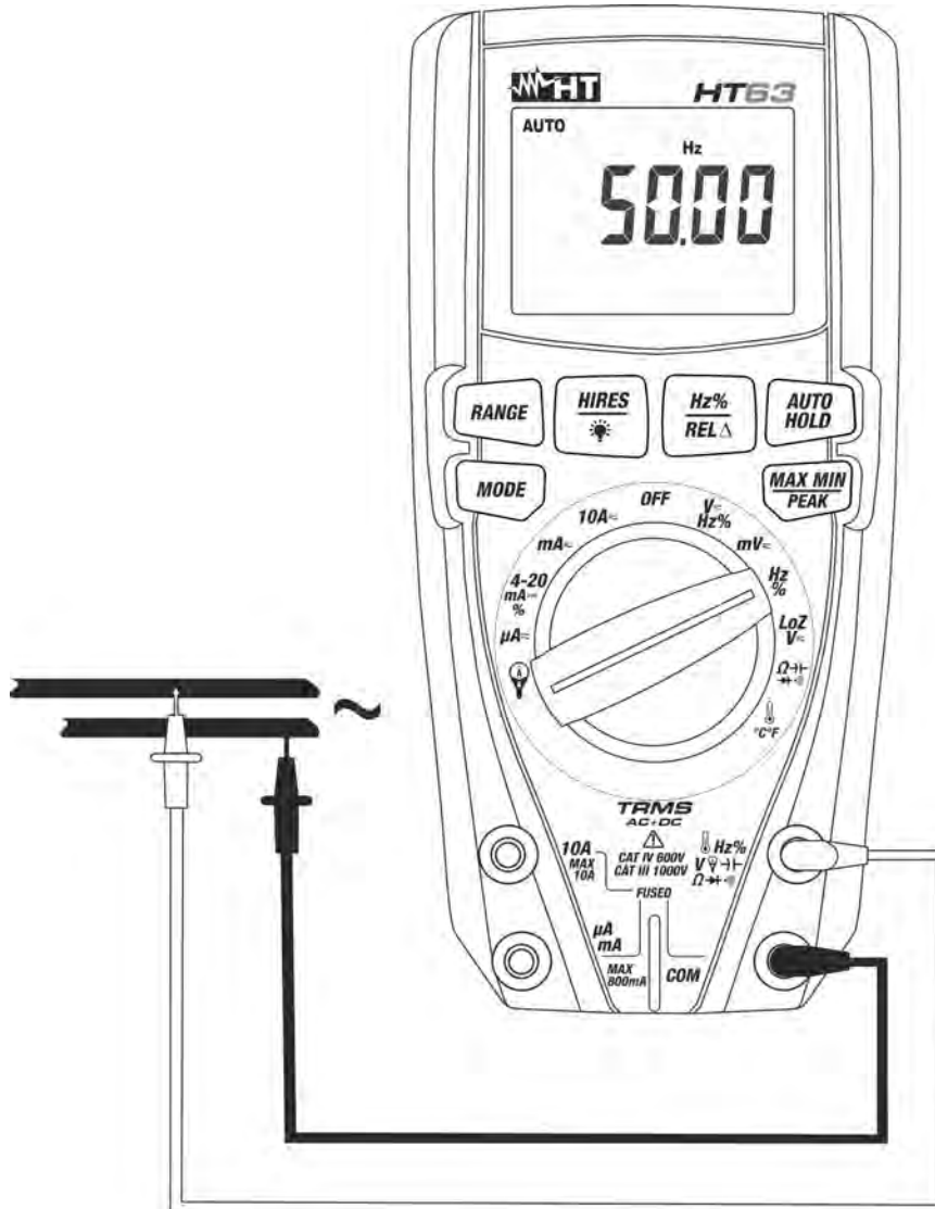
Abb. 5: Verwendung des Gerätes für Frequenz- und Duty Cycle-Messungen
