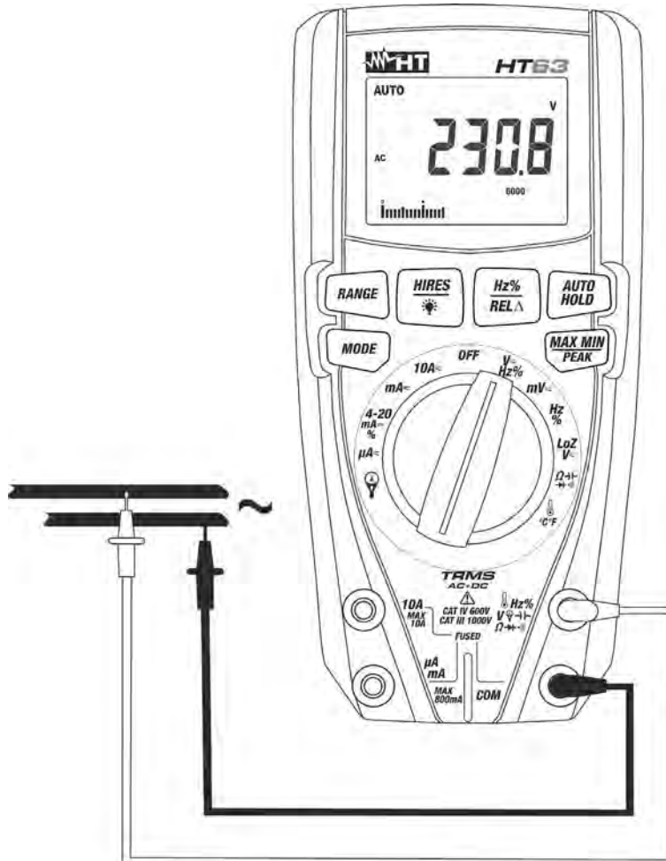
Abb. 3: Verwendung des Gerätes für Wechselspannungsmessung
