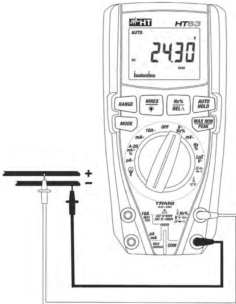
Abb. 2: Verwendung des Gerätes für Gleichspannungsmessung
